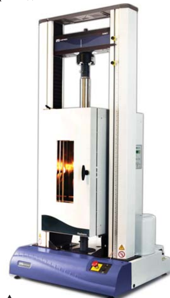
▲ Модель 3367 настольного типа с камерой инфракрасного нагрева
